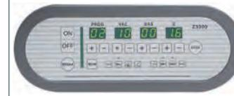
Affichage du vide en % et mbar et réglage du temps de soudure. Touche Stop pour interrompre le cycle de mise sous vide (liquides). Programme de déshumidification de la pompe à vide (DAL). Détection point d'ébullition, fonction viande rouge, vide par palier, Softair. Injection de gaz pour éviter l'écrasement des produits (option).
