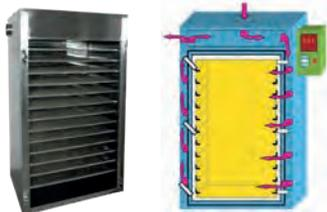
Schéma de circulation horizontale de l'air chaud
