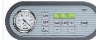
Réglage simple et précis du temps de mise sous vide et de soudure. Touche Stop pour interrompre le cycle de mise sous vide (liquides). Programme de déshumidification de la pompe à vide (DAL). Injection de gaz pour éviter l'écrasement des produits (option).
